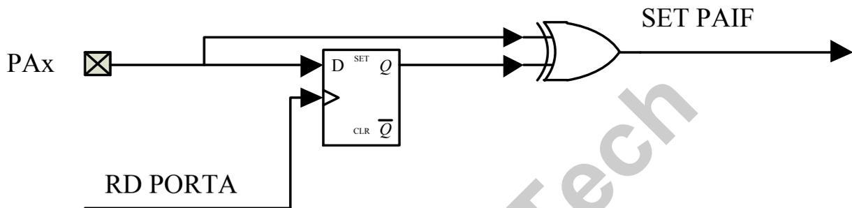
10.2 端口变化中断原理框图
