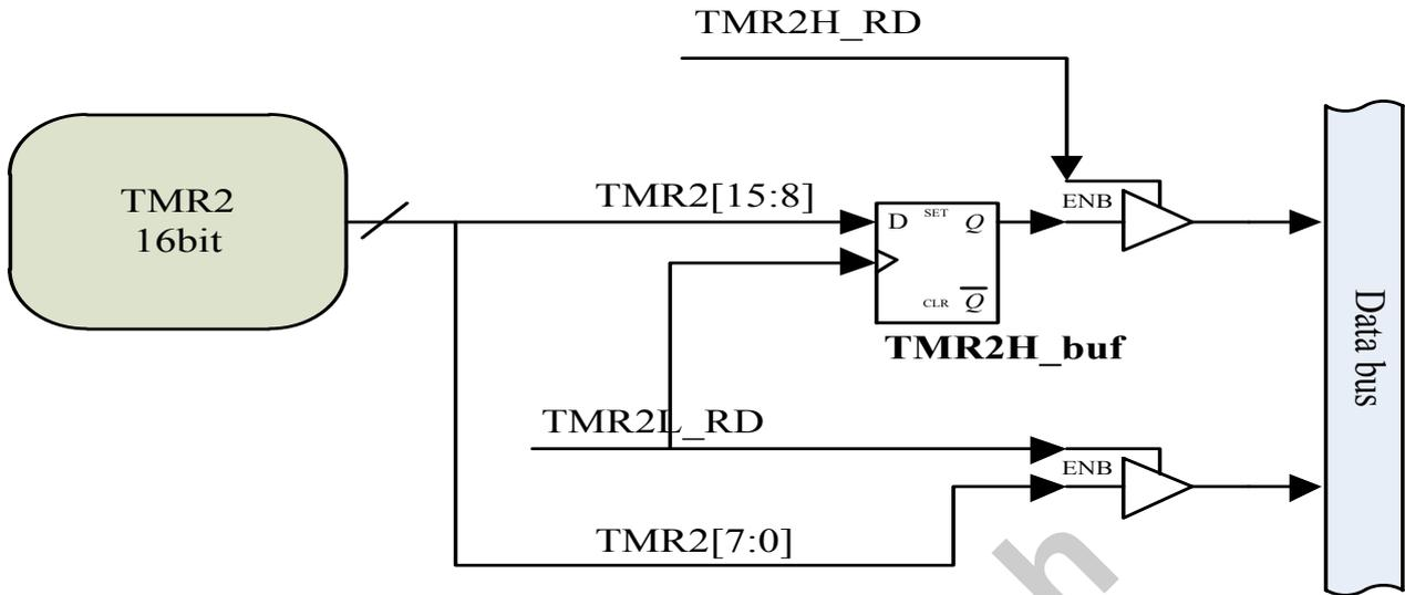
图 7.2 Timer2 计数值的读操作原理框图
