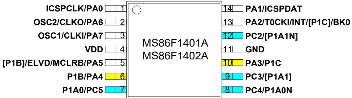
图 1.6 SOP14 脚位, MS86F1401A/MS86F1402A
