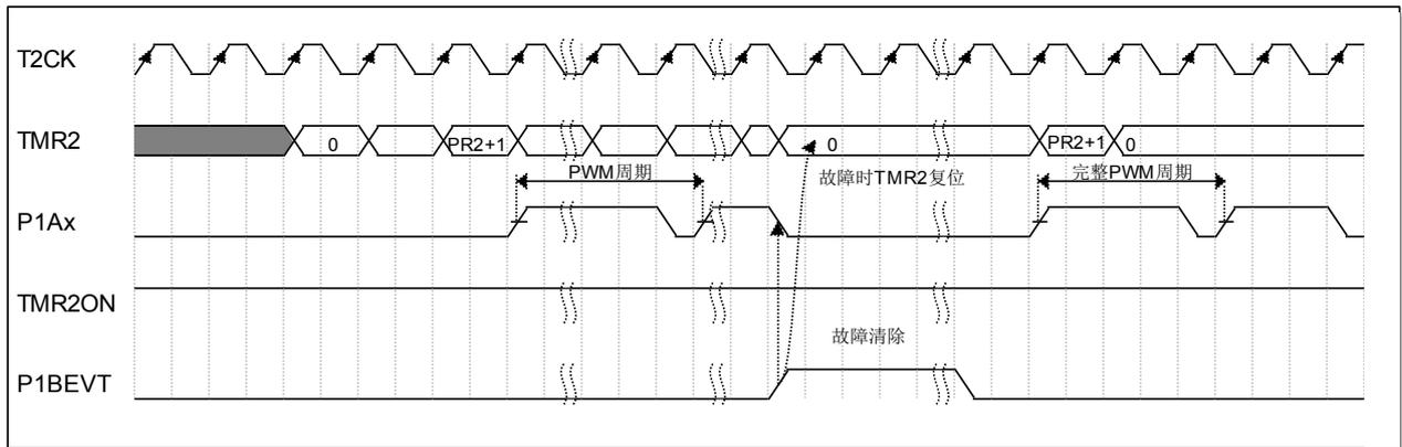
图 9.6.1 PWM 的自动重启时序图
