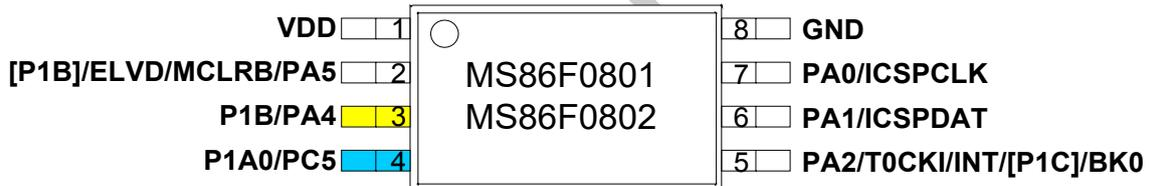
图 1.9 SOP8 脚位, MS86F0801/MS86F0802
